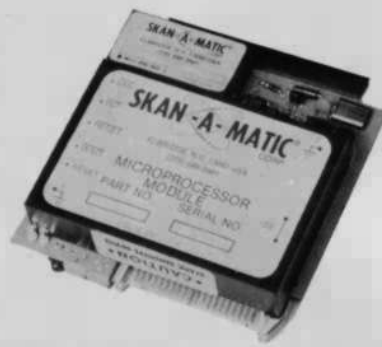
Bild 4. Das sogenannte intelligente Herz eines Strichcode-Auswertesystems – ein Mikrocomputer mit dem Z80 als CPU
