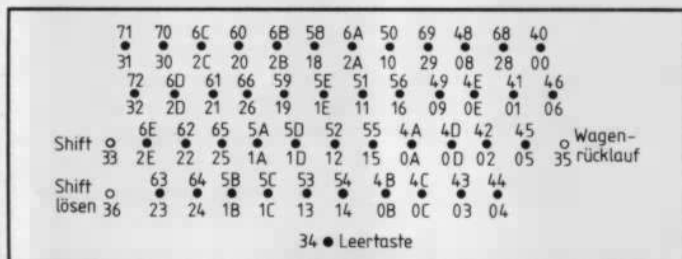
Bild 2. EMUF als V.24-Schnittstelle für den Schreibmaschinen-Drucker. Format des Eingangssignals: 8 Bit oder 7 Bit mit Parität (das 8. Bit wird in jedem Fall ignoriert)
