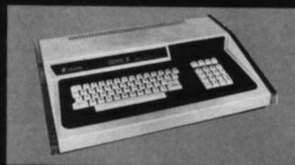
Genie II – Personal-Computer mit 12 k ROM und extrem leistungsfähigen TRS-Level II Basic, 16 k freier Benutzerspeicher, CPU: Z 80, prof. Tastatur mit Numeric PAD, Groß- und Kleinschrift.
