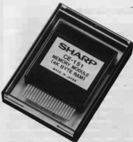
Bild 2. 4-KByte-Speichermodul. Solange es im Rechner eingesetzt bleibt, gehen die Informationen auch beim Ausschalten des PC-1500 nicht verloren
