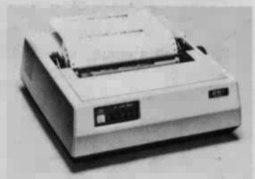
Microline 82 A 120 Zeichen/s, Bidirektionaler Druck, 40, 80 und 132 Zeichen/Zeile, 9 Zeichensätze, Grafik.
