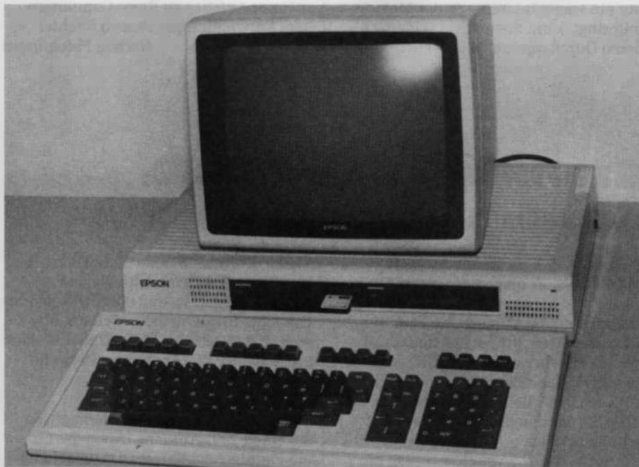
Der QX-10 besteht aus drei voneinander absetzbaren Teilen: dem eigentlichen Computer, dem Monitor und der Tastatur
