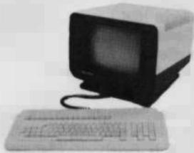
Z80-CPU mit UR-Lader im EPROM, 12"-Bildschirm mit 24 Zeilen x 80 Zeichen, superschnelles System durch bus-paralleles MEMORY-MAPPED-VIDEO und „RAM-FLOPPY“, 5,25"- oder 8"-Floppy-Disk-Laufwerke SINGLE- oder DOUBLE-DENSITY, V24- und Centronics-kompatible Druckerschnittstelle, 256 K-Byte RAM-Speicher m. 64K bestückt, LCS-Tastatur m. über 100 Tasten, Software: WordStar, DataStar, Basic-80...
