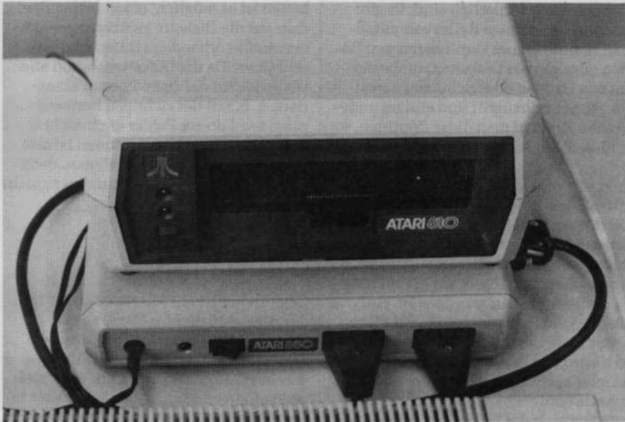
Bild 2. Unter der Diskettenstation befindet sich das RS-232-Interface 850, das auch die Parallelschnittstelle für den Centronics-Drucker enthält
