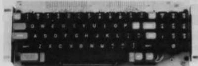
Neue, moderne Tastatur (Reed-Kontakt-Schalter), mit 66 Tasten zweifarbig (grau/schwarz) einschließlich 10er Tastenfeld, mit offenem X/Y-Ausgang für völlig frei wählbaren Encoder, besonders geeignet zur Umrüstung für ZX 80/81 (da von unten zugängliche Matrix) Epoxy-Platine, Maße: 13,7 x 32,5 cm.
