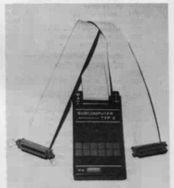
Entlastet Computer beim Drucken: Subcomputer II
