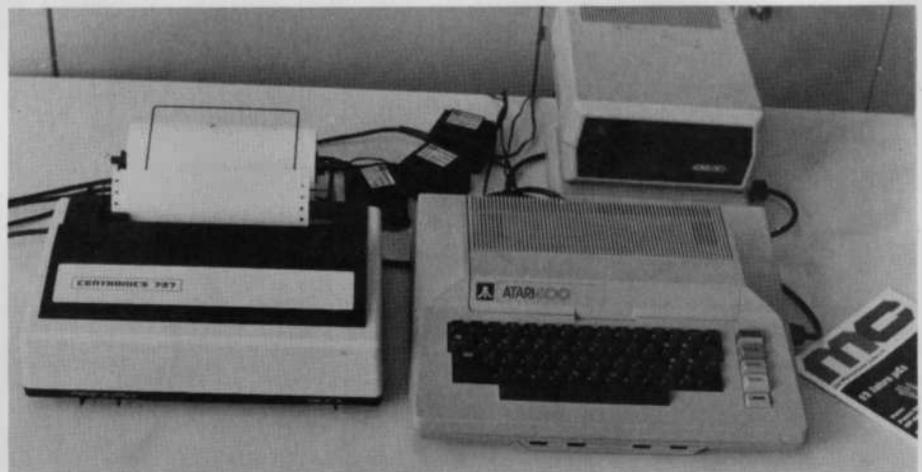
Bild 1. Die Testkonfiguration bestand aus dem Atari-800, Diskettenstation 810, RS-232-Interface 850 (verdeckt) und einem Centronics-Drucker 737 (Atari 825)
