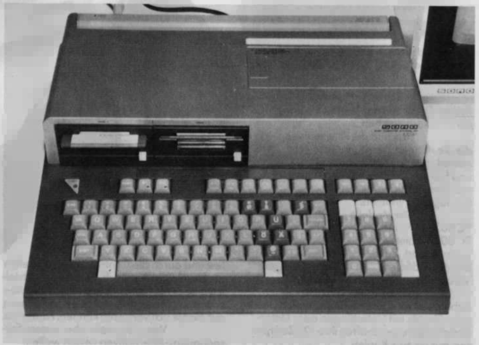
Bild 1. Einer der ersten Computer mit Mikrofloppies: Der M23P von Sord-Mitsui
