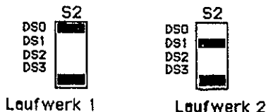
Abb.3: Einstellung des Jumpers S2 für Laufwerk 1 und Laufwerk 2
